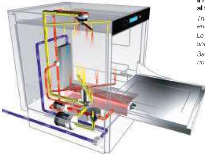
**Il riempimento del serbatoio avviene solo al termine del ciclo di risciacquo.**
